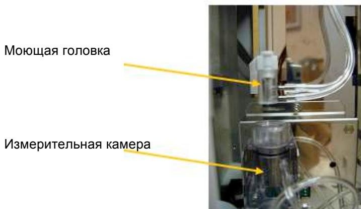
Рис. 12. Измерительный блок.
