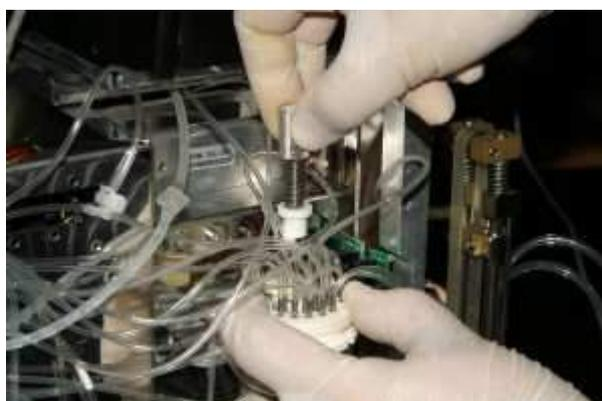
3. Сдвиньте верхний диск клапана вниз. В силу исключительно гладкой поверхности керамических дисков его невозможно просто поднять. Если распределяющий клапан несколько дней не использовался, капните несколько капель воды на место соприкосновения верхнего и нижнего дисков.
