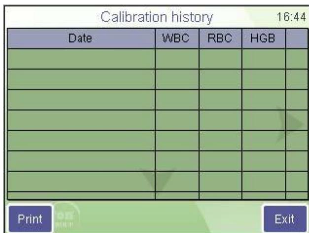
Можно сравнить целевые и измеренные значения, просмотреть коэффициент вариации (CV) и изменение калибровочного фактора.
